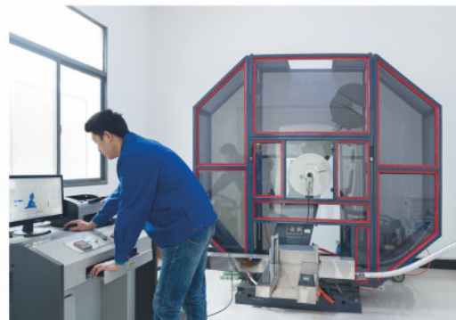
超低温冲击试验机 Ultra low temperature Impact testing machine
